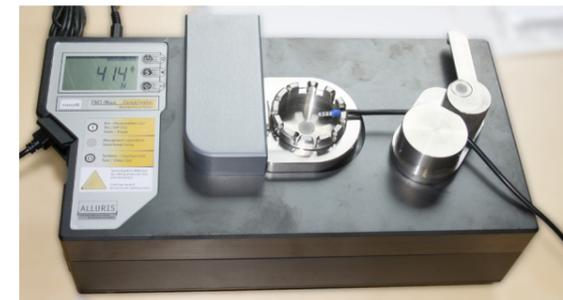
**Abzugskräfte in der Kabelkonfektionierung können jetzt in einem automatisierten Prozess geprüft werden.**
