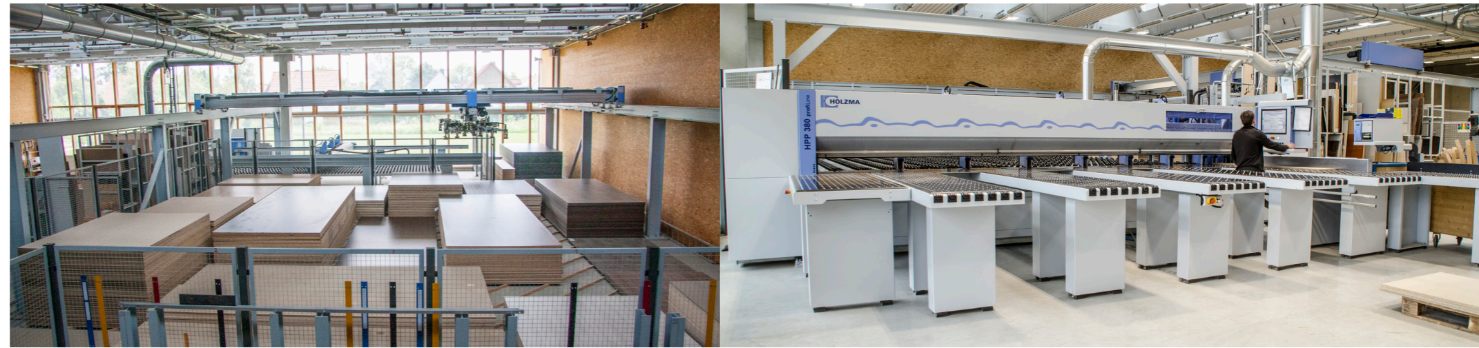
Moderne Plattenlagerung (Bild links) mit computergesteuerter Zuführung für den horizontalen Zuschnitt (Bild rechts)
